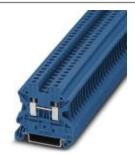
Проходные клеммы, номинальное напряжение: 1000 В, номинальный ток: 24 А, тип подключения: Винтовые зажимы, количество точек подсоединения: 2, сечение:0,14 мм $^2$  - 4 мм $^2$ , AWG: 26 - 12, ширина: 5,2 мм, высота: 46,9 мм, цвет: синий, тип монтажа: NS 35/7,5, NS 35/15
