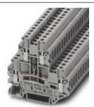
Двухъярусные клеммы, тип подключения: Винтовые зажимы, сечение:  $0,14 \text{ мм}^2$  -  $4 \text{ мм}^2$ , AWG: 26 - 12, ширина: 5,2 мм, цвет: серый, тип монтажа: NS 35/7,5, NS 35/15
